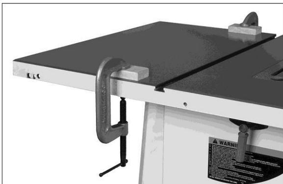
Рис. 6-6: выравнивание расширения стола, метод 1
